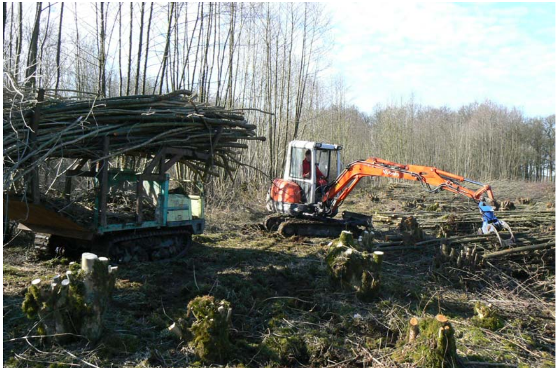
De huidige gebruikte methode met het overdragen van de scheuten met een minikraan naar een aangepaste dumper, die het hout vervolgens uitrijdt naar de berijdbare bosweg (foto onder).
