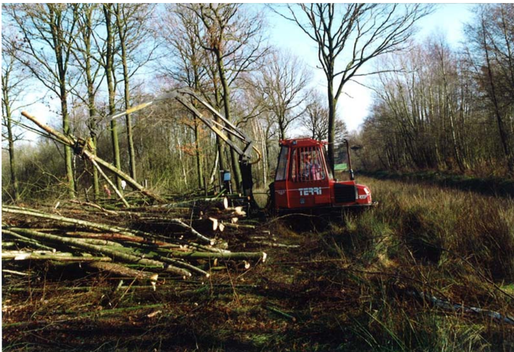
Er zijn talloze kleine uitdraag- en uitsleptrekkers beschikbaar. Op de bovenste foto de Alstor 8x8 in een hakhoutperceel op rabatten op landgoed Hoevelaken en onder een Terri in een nat hakhoutperceel op landgoed Twickel.
