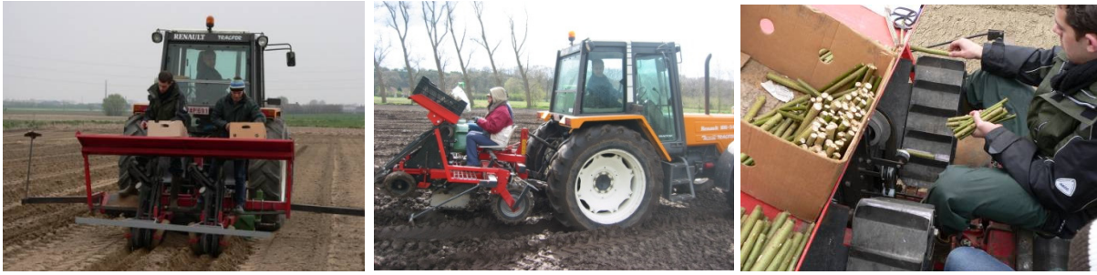
Foto: Aanplant van stekken met behulp van een preplanter
