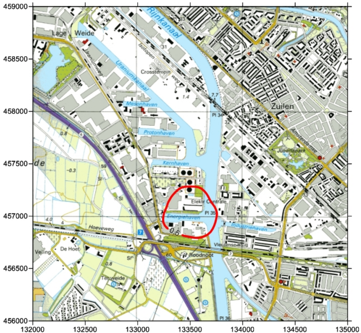
Abbeelding 15: Geurcontour van 0,5 \text{ ouE/m}^3 als 98-percentielwaarde als gevolg van de biomassacentrale Nuon Groene Weide bij een schoorsteenhoogte van 65 m en aanvoer van biomassa middels schepen en per as (70 : 30)
