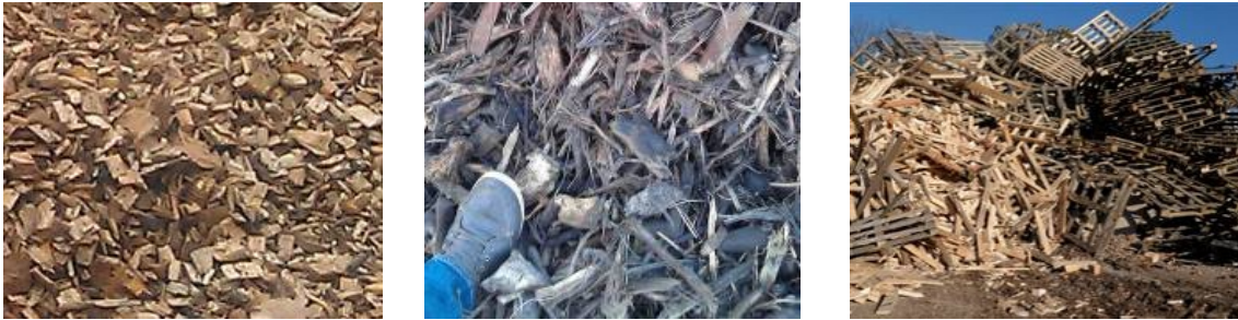
Afbeelding 9: Voorbeelden van houtige biomassa. Links: houtsnippen uit bosexploitatie. Midden: gebroken hout uit snoeihout. Rechts: gebruikt hout
