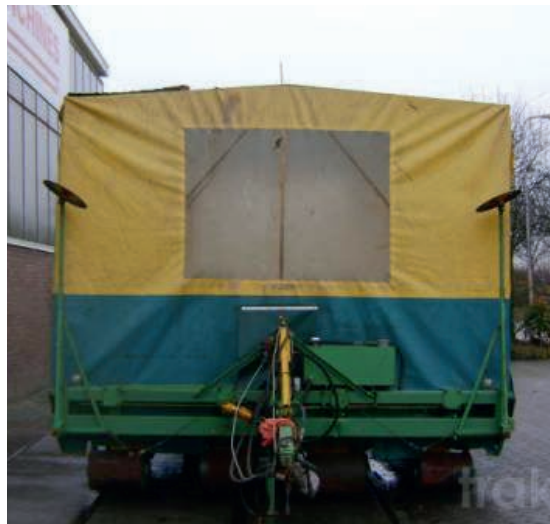
Figuur 2.6: Koolplanter van het merk Ploeger. Rechts wordt de binnenkant van de koolplanter weergegeven met daarin de zitplaatsen voor de planters en de carrousel waar de koolplantjes (of wilgenstekken) in kunnen worden geplaatst. Bron foto's: www.traktorpool.nl .
