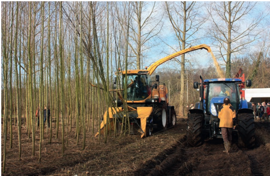
Figuur 2.11: Coppice Header 130 FB van Case New Holland gemonteerd op een maishakselaar. Bron foto: Martijn Boosten.
