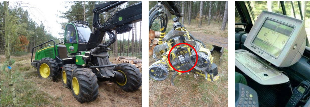
Foto 7 (links): Harvester, foto 8 (midden): velkop, meetwiel in het midden, foto 9 (rechts): boordcomputer met velgegevens
