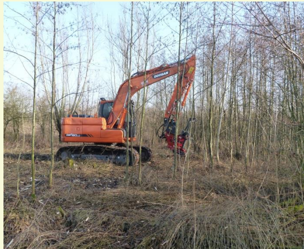
De Brushcutter is een oogstkop die op een rupskraan kan worden gemonteerd en zeer geschikt is voor het oogsten van elzenhakhout in waterbergingen.
