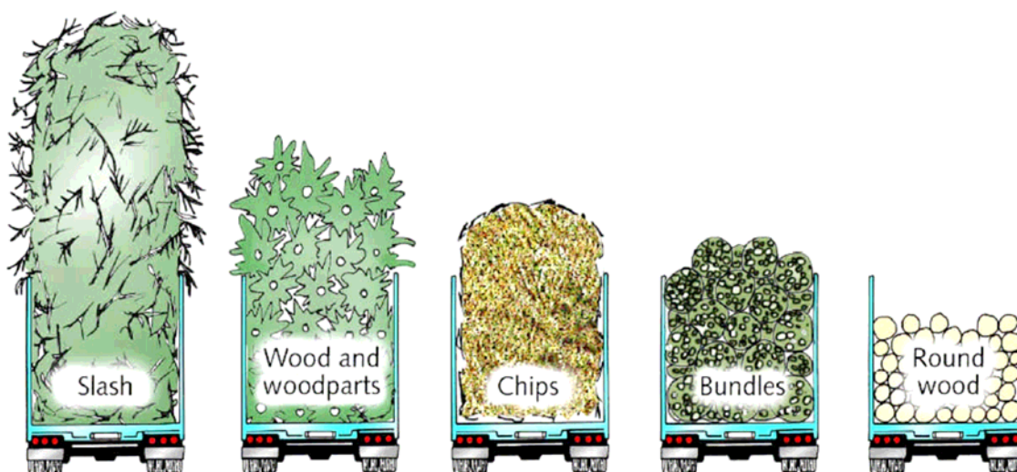
Figuur 4.5 – De ruimte die eenzelfde gewicht aan takhout, houtdelen, houtsnippers, takkenbundels en rondhout innemen op een aanhanger verschilt nogal (Lechner, 2004)
